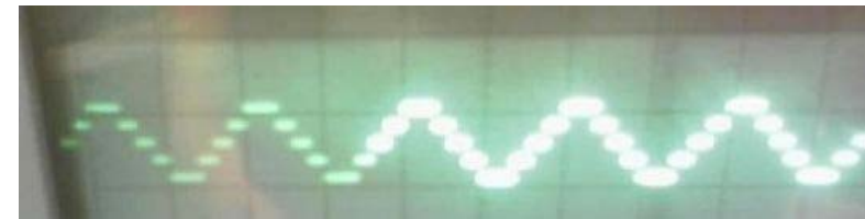
6024E 100Hz triangle wave output
